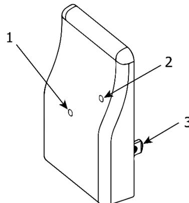
Le répéteur 99-RX02 doit être installé à mi-chemin entre la minuterie sans fil 99-DET02 et la commande murale principale si la minuterie est hors de portée. La DEL indiquera la force de connexion entre le répéteur et la commande murale principale, comme sur le tableau ci-dessous. Corriger la position du répéteur au besoin.
